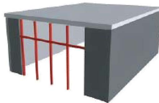
الف- اضافه کردن دیوارهای سازه ای
